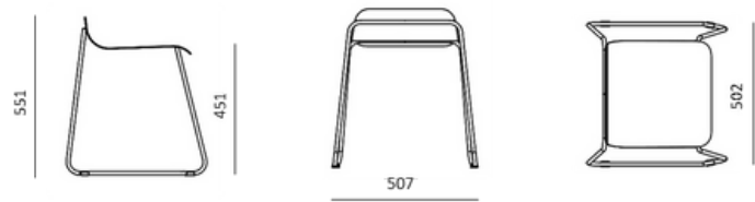
elevação frontal elevação lateral vista superior
